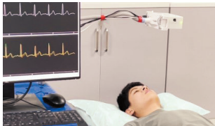
毫米波非接触心电图实时监测
