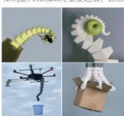
队首次提出基于对数螺旋线结构的新螺旋软体机器人，相关研究成果发表在Cell Press（细胞出版社）旗下期刊Devex上。
