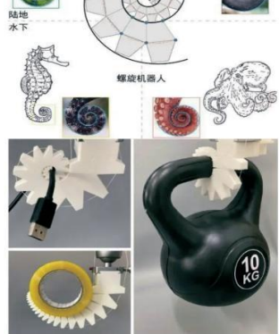
生物肢体的螺旋线形态及本研究所设计的螺旋机器人部分样机
